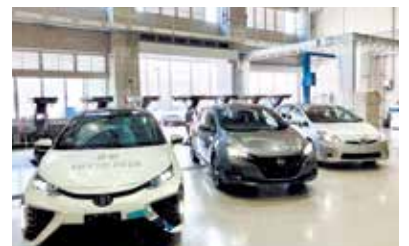
実習車両（左からFCV、EV、HV）
