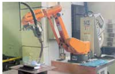
ロボット溶接作業
