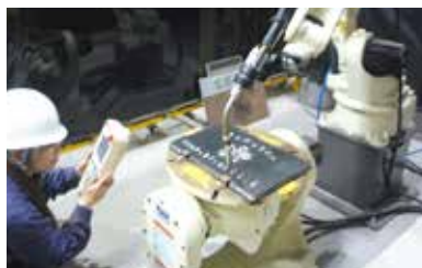
ロボット溶接作業
